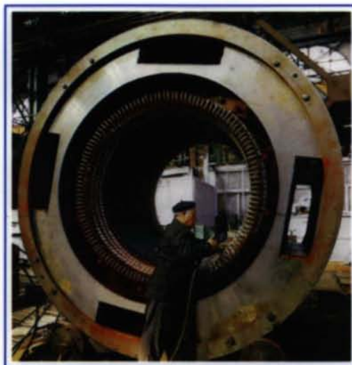
Обмотки электрических машин
