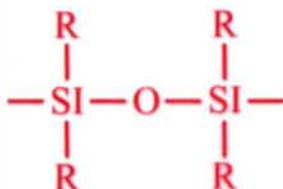
ОПН. Защитная кремнийорганическая оболочка.
